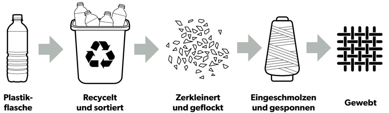
Zehn 0,5 l-Plastikflaschen ≈ 1 Meter Redux-Material
