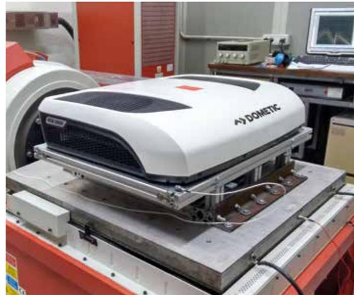
Le CoolAir RTX a fait montre de sa robustesse lors d'une série de tests difficiles, ex. le contrôle du cycle de vie accéléré. Les tests ont eu lieu sur le banc à secousses ainsi qu'en chambre climatique.
