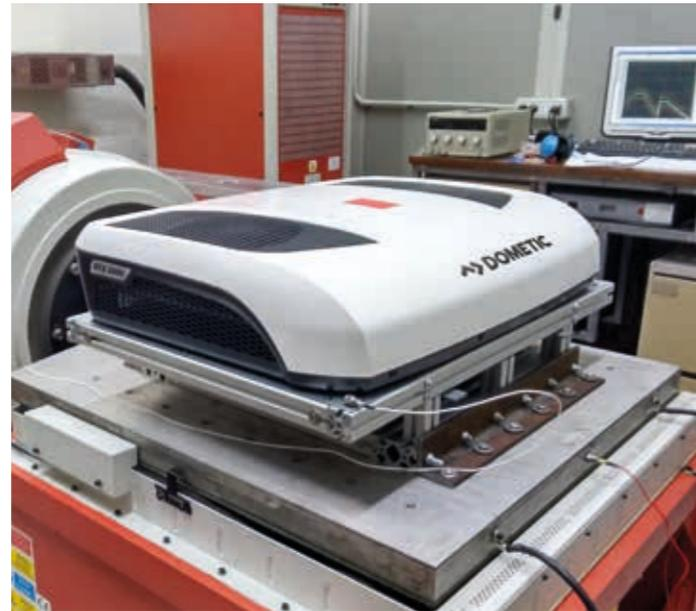
Le CoolAir RTX a fait montre de sa robustesse lors d'une série de tests difficiles, ex. le contrôle du cycle de vie accéléré. Les tests ont eu lieu sur le banc à secousses ainsi qu'en chambre climatique.
