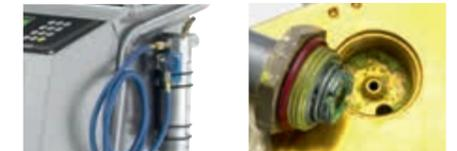
Auswirkung des Dichtmittels in dem Klimaservicegerät ohne Verwendung des Recycle Guards
