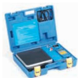
Balances pour fluide réfrigérant
