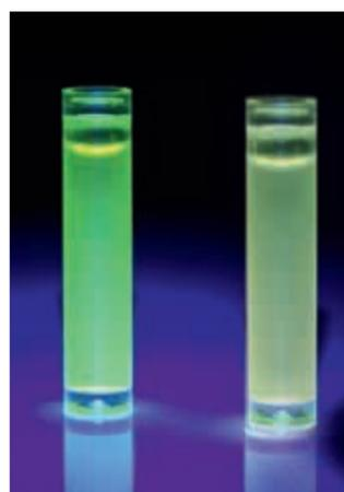
Des quantités de charge de fluide réfrigérant qui diminuent dans les systèmes de climatisation des véhicules font qu'un équipement de détection des fuites plus sensible est nécessaire. C'est là que TRACER®, une marque de qualité, fournit une solution convaincante avec ses additifs hautement fluorescents et sa technologie avancée de LED à rayons UV à lumière bleue.
