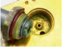
Contamination par mastic dans la station d'entretien de climatisation sans l'utilisation du Recycle Guard
