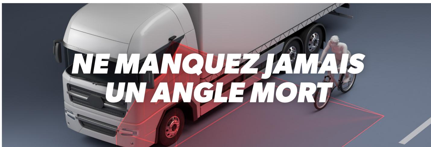
Contrairement aux solutions latérales conventionnelles, cette caméra d'assistance angle mort distingue de manière fiable les objets en mouvement tels que les piétons des objets statiques comme les réverbères. En clair, le conducteur n'est averti qu'en cas de danger réel. LED infrarouges intégrées pour garantir une qualité d'image optimale de jour comme de nuit.
